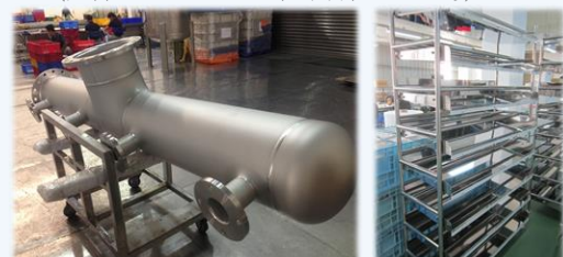
各種特注加工品 (配管プレファブ加工、架台、はしご等)
